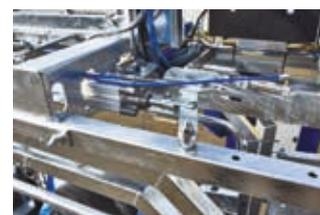
Vérins pneumatiques fonctionnant sur une pression de 5 bars. Diamètre des vérins étudié en fonction des efforts à opérer pour l'ouverture de chaque élément. Chacun des éléments manipulés par les vérins est équipé de sécurité mécanique à butée franche permettant de limiter les efforts et casses des vérins, notamment lors de poussées animales.
