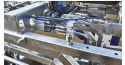
Vérins pneumatiques fonctionnant sur une pression de 5 bars. Diamètre des vérins étudié en fonction des efforts à opérer pour l'ouverture de chaque élément. Chacun des éléments manipulés par les vérins est équipé de sécurité mécanique à butée franche permettant de limiter les efforts et casses des vérins, notamment lors de poussées animales.
