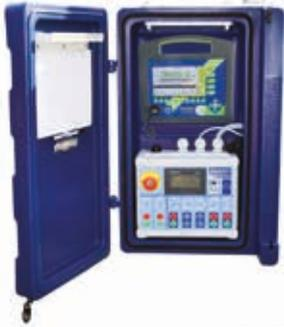
Armoire en polyéthylène étanche à fermeture cadénassable fixée sur un bras amovible et réversible. Equipée du boîtier de pesage P05 et du boîtier de commande des vérins pneumatiques.
