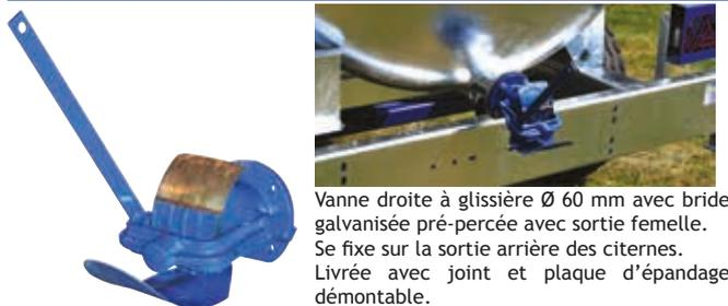
Vanne droite à glissière Ø 60 mm avec bride galvanisée pré-percée avec sortie femelle. Se fixe sur la sortie arrière des citernes. Livrée avec joint et plaque d'épandage démontable.
