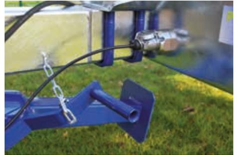
Rallonge électrique du châssis au tracteur (fournie), évitant la détérioration du faisceau par les animaux. Connexion des feux arrière avec passage de fil directement dans le châssis.
