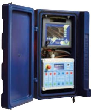
Une armoire en polyéthylène étanche à fermeture cadenassable fixée sur un bras amovible et réversible. Prévue pour recevoir l'indicateur de pesée (en option P01 ou P05) et le boîtier de commande des vérins pneumatiques.
