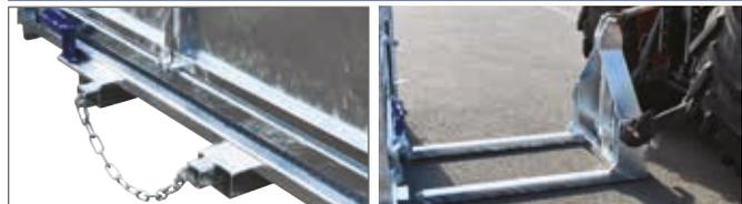
Attelage 3 points de catégorie 2 pour cages à parois variables. Bâti construit en tôle mécano-soudée d'épaisseur 12 mm avec bras de levage en tube 70x6 mm. Livré avec chaîne de sécurité.
