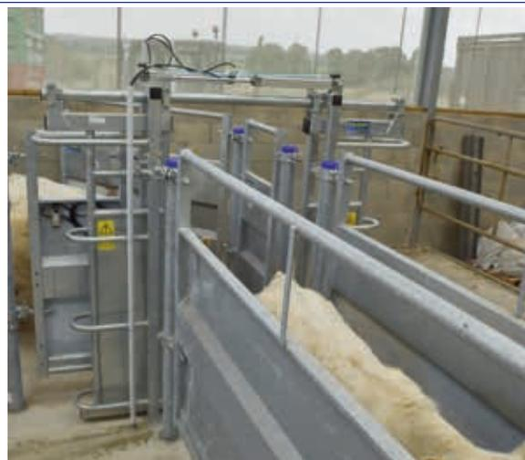
Prévoir une alimentation pneumatique de pression 5 bars par boîtier de commande ou par automate de cage.
