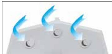
3 trappes de ventilation réglables situées à l'arrière en partie haute. Circulation d'air dans la niche limitant ainsi la condensation.
