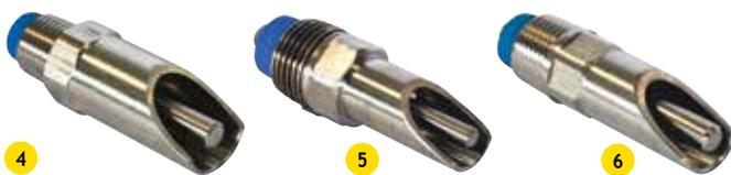
Les tétines sont fileté en 1/2" et munies d'un filtre d'origine. Elles doivent être fixées directement dans les coudes inox à 15° ou 45° reliés au tube inox, de longueur adaptée suivant l'âge de l'animal. Nos abreuvoirs et nos tétines d'abreuvement sont réalisées en inox 304 de haute qualité. Leurs tailles et formes sont adaptées à la morphologie des porcs en fonction de leur âge/ Leur raccord par inox mâle/femelle 1/2, équipé d'un régulateur de débit.
