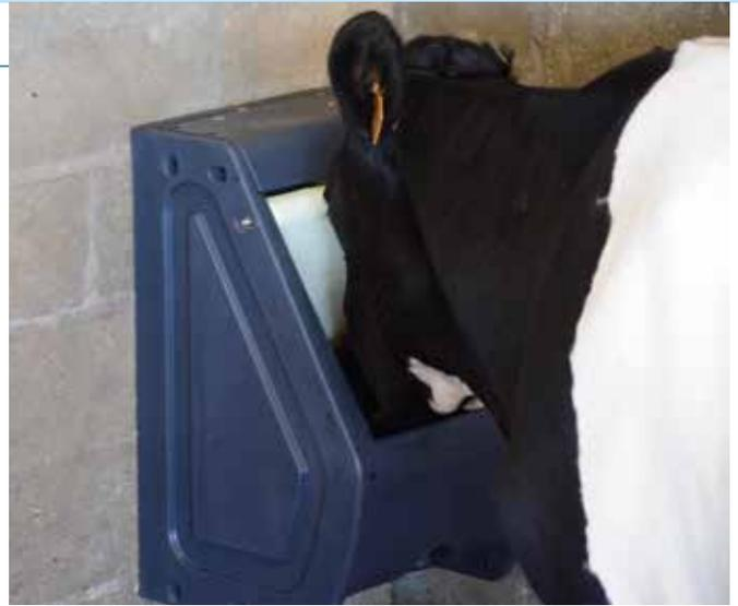
Possibilité d'enlever le ressort de la trappe pour condamner sa fermeture automatique (dans ce cas la trappe protège le mécanisme flotteur) pour un accès direct des animaux à l'eau ou pour la période d'apprentissage.
