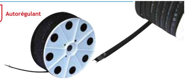
Le ruban chauffant permet la mise hors gel et évite d'éventuelles détériorations des alimentations en eau en tuyauteries métalliques. Il est réalisé à partir de deux fils conducteurs d'électricité entourés d'un isolant chargé de particules de graphite conductrices.
