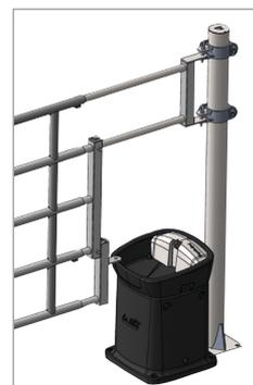
Einschubteil mit einer Tränke/Säule Ausnehmung. Befestigung-Zwischenachse für die Säulenausnehmung: 340 mm. Befestigung-Zwischenachse für die Tränkeausnehmung: 948 mm. Nur mit den Ø 42,4 mm Weidetor Hauptteilen kompatibel.
