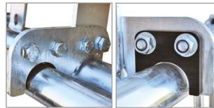
Der Doppelrahmen wird von technischen Teilen aus Ertalon gefertigt, dies gewährleistet eine geräuscharme Führung.
