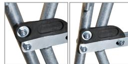
Patentierter, auf Zahnstange montierte „Einseitige Gummifeder“ auf jedem beweglichen Hebel zur automatischen Rückkehr in geöffneter Position. Die Befestigungsschache des beweglichen Hebels ist mit einem Verstärkungsring ausgerüstet, um eine gute Lebensdauer zu gewähren. Die einseitige Gummifeder ist vor den Kälbern geschützt.
