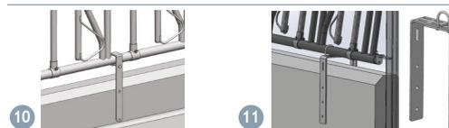
Zwischenverstärkung zur Befestigung eines Selbstfangfressgitters auf Barenwand. Mit den SR, SF, SRS und LR Selbstfangfressgittern, den Palisadengittern und den Diagonalfressgittern kompatibel.
