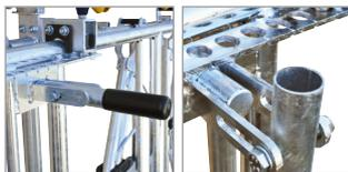
Abklappbarer Griff zur Halsweiteinstellung. Die Halsweiten aller Plätze können durch Betätigen eines einzigen Griffes gleichzeitig eingestellt werden.
