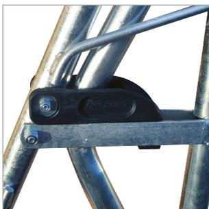
„Gummifeder“ patentiertes System auf jedem beweglichen Hebel zur automatischer Rückkehr in die geöffnete Position mittels einer Gummifeder auf Gleitschiene. Die Befestigungsachse des beweglichen Hebels ist mit einem Verstärkungsring ausgerüstet, um eine gute Lebensdauer zu gewähren.
