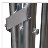
Hebelachse verstärkt und in einer Muffe gelagert.
