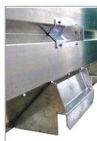
Dreipunktaufhängung, durch eine dicke, verschraubte Platte verstärkt.
