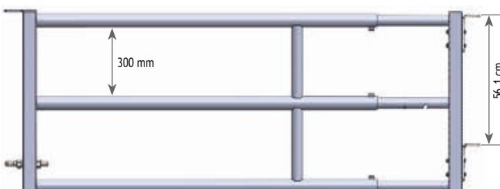
Livré d'origine avec 2 plats de fixation à boulonner sur le montant avant du panneau pré-percé pour les recevoir à l'entraxe de 56,1 cm.
