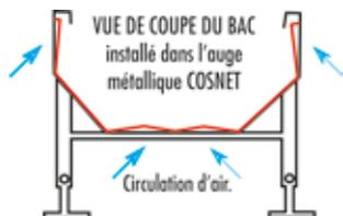
Fabriqué en résine de polyéthylène et stabilisé au U.V et au gel, il est particulièrement résistant aux acides. Il optimise la longévité des auges métalliques neuves. Une fois intégré dans le bac, le bouchon de vidange de l'auge métallique doit être enlevé pour la ventilation interne des parois. Pour auges métalliques standards peintes, standards galva et renforcées de 5 x 0,80 m.
