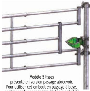
Modèle 5 lisses présenté en version passage abreuvoir. Pour utiliser cet embout en passage à buse, positionner la seconde tige filetée à oeil Ø 22 mm en partie haute de l'embout. Peut être équipée d'une troisième tige à oeil de fixation en option.
