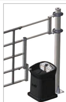
Embout avant conçu pour laisser un passage pour un abreuvoir ou une buse. Entraxe de fixation en passage buse : 340 mm. Entraxe de fixation en passage abreuvoir : 948 mm. Compatible uniquement avec les arrières herbage Ø 42,4 mm.
