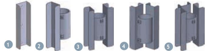
Elles sont prévues pour être montées sur poteaux nus Ø 102 mm et recevoir des bastinges de larg. 75 mm par haut. 225 mm (soit du 8x23 cm). Les brides supports bastinges pour tables d'alimentation permettent le montage et démontage rapide des soubassements.
