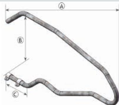
Se pose à même le sol. Forme prévue pour pouvoir laisser passer les arrêteurs de logettes en ligne complète.
