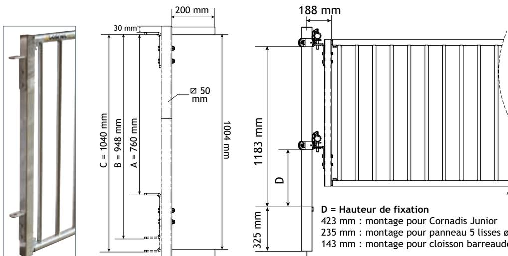
Cet embout, fixé en lieu et place des embouts réglables des cloisons de séparation barreaudées Ø 42,4 mm, permet d'obtenir des ensembles ajustables en longueur avec un entraxe de fixation réglable.
