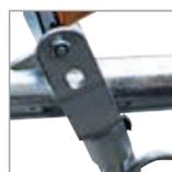
Barre mobile équipée d'un tampon antibruit en partie haute pour limiter le stress des animaux.
