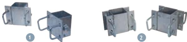
Ces brides sont prévues pour être fixées sur les poteaux en  $\varnothing$  80 mm. Les étriers sont prévus pour recevoir les poutres en  $\varnothing$  60 mm qui servent de fixation pour les bat-flancs de logette. Les brides simples permettent une installation simple rangée et les brides doubles une installation double rangées. Voir schéma page 74
