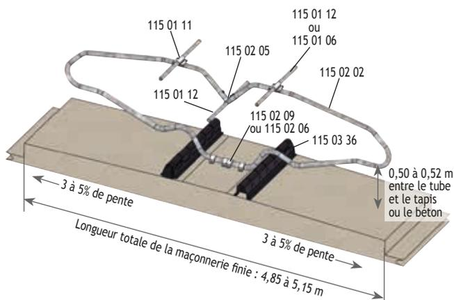
Exemple de pose de bats-flanCS de logette autoportants PACIFIQUE en vis à vis
