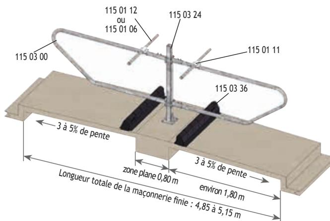
Exemple de pose bat-flancs de logette **ATLANTIQUE** directement sur support en vis à vis
