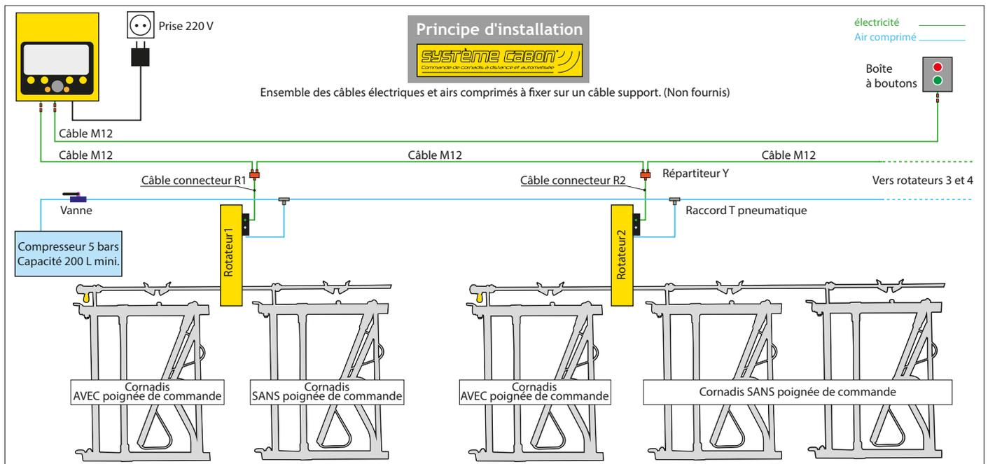
Règles à respecter pour le montage d'une installation "SYSTEME CABON" sur une ligne de cornadis.
