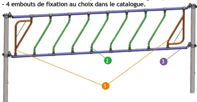
Pour un bon accès des animaux au libre-service, la largeur de passage de tête doit être comprise entre 300 et 400 mm. Elle peut également être adaptée en fonction de l'âge des animaux.
